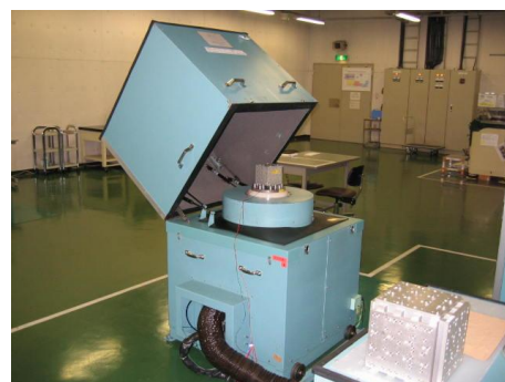
写真7 振動試験（振動ストレス）
