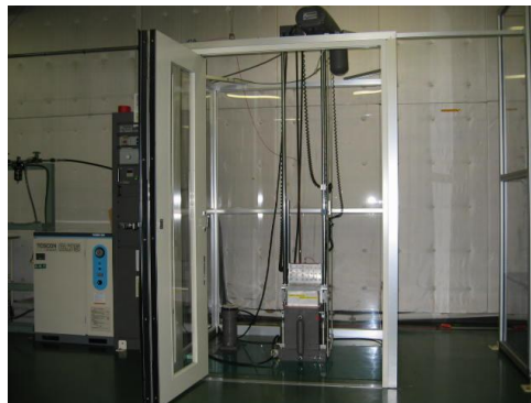
写真6 衝撃試験（落下衝撃ストレス）
