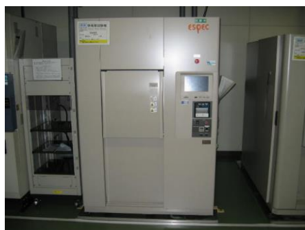
写真5 熱衝撃試験（高温⇔低温）
